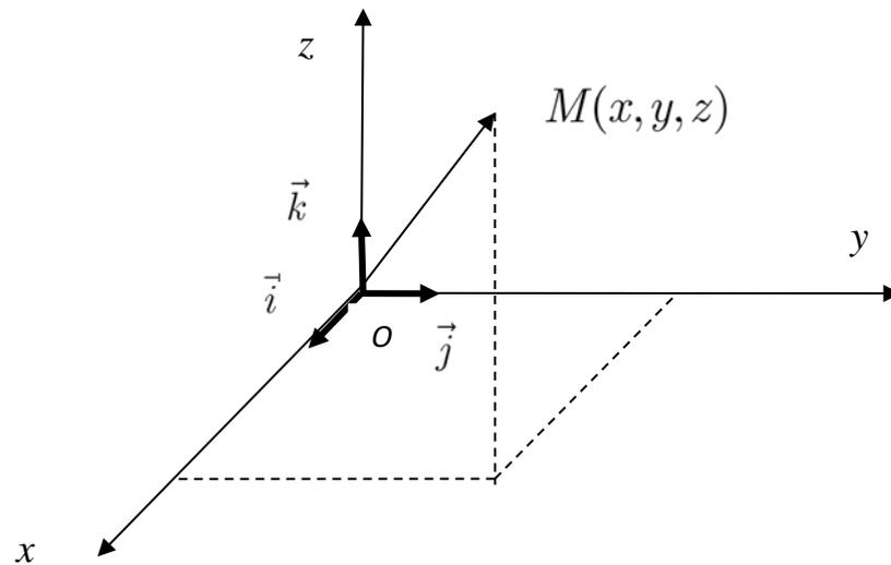
Рис. 10.2. Декартова система координат в пространстве.
